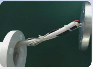
2, conecte tres cables de la turbina eólica al cable de transmisión, cada longitud del cable empalmado es de al menos 30mm; sujete los cables con cinta, su longitud es de aproximadamente 100mm. (hágalo como muestra la imagen de arriba)
